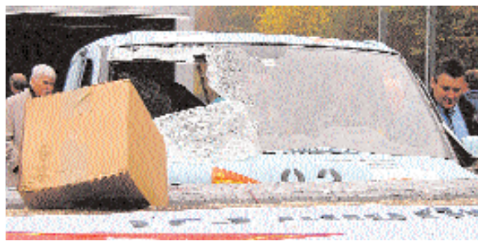
Enorme Kräfte: Was ungesichert ist, schießt bei einem Aufprall aus dem Fahrzeug. Bild: szb
